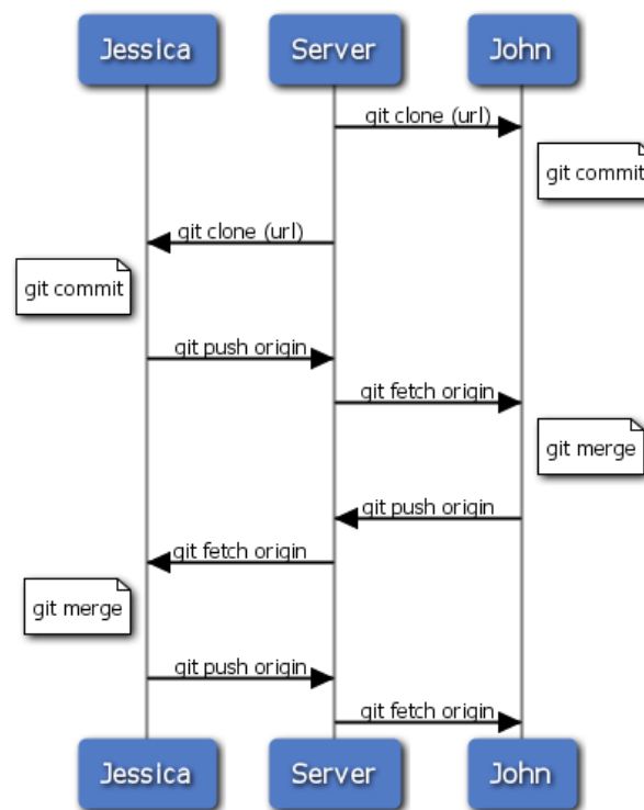
Рисунок 5.11: Общая последовательность событий для простого рабочего процесса с несколькими разработчиками в Git'e.
